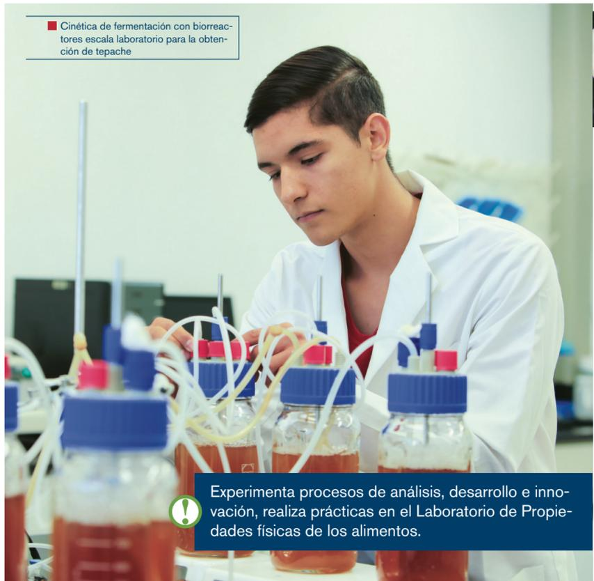
Cinética de fermentación con biorreactores escala laboratorio para la obtención de tepache
